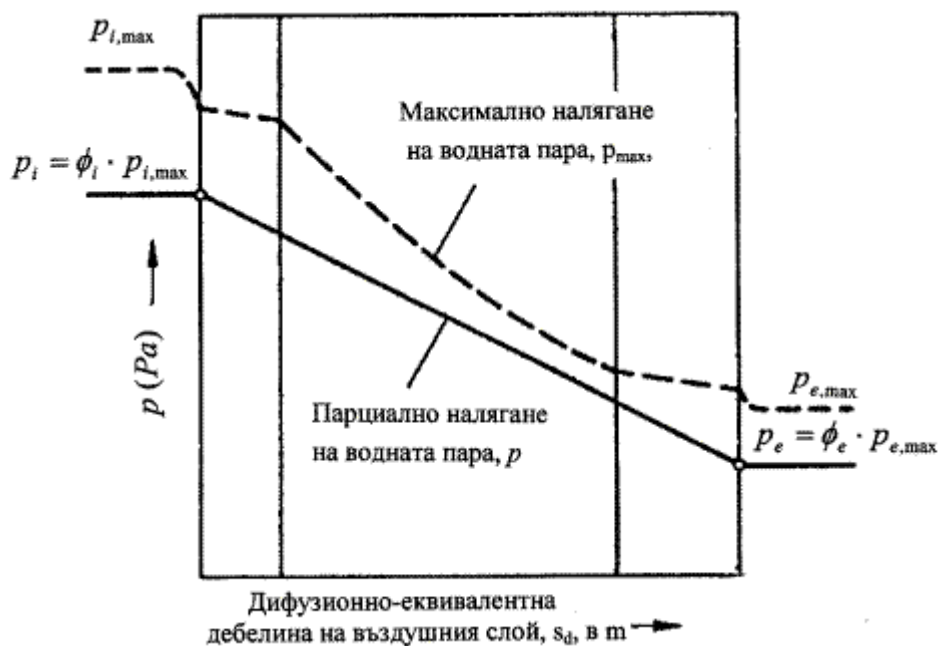
Фиг. 6.2. Схема на максималното и парциалното налягане през многослойна ограждаща конструкция или елемент, съответстващи на температурата, за изчисляване на евентуален кондензационен пад
