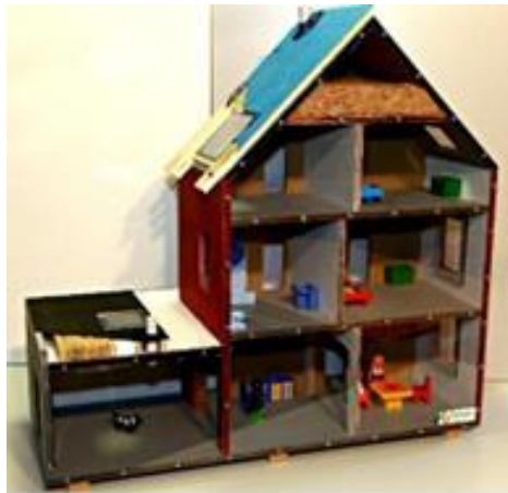
Фигура 10. Пример за педагогически инструмент, който илюстрира влиянието на херметичността върху механичната вентилация чрез пускане на генератор на дим
